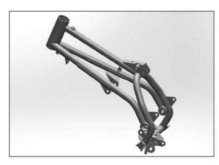
• Contrôler si le cadre présente des fissures et des déformations.
