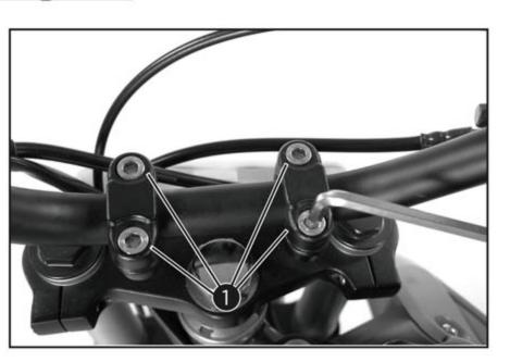
Enlever les vis 1 des demi-coquilles supérieures du support de guidon. Mettre en place le guidon et les demi-coquilles et serrer les vis 1 à 29 Nm. L'espace entre le support de guidon et les demi-coquilles doit être le même vers l'avant et vers l'arrière.
