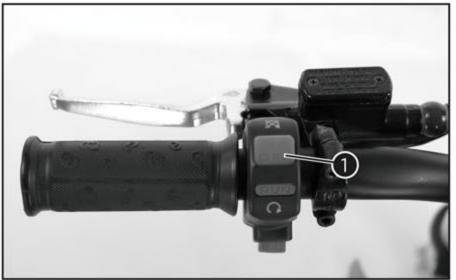
Le bouton de masse 1 est situé sur le côté gauche du guidon.
