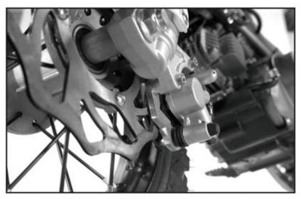
• Mettre en place les plaquettes de frein neuves, insérer l'axe et monter la goupille à ressort.
