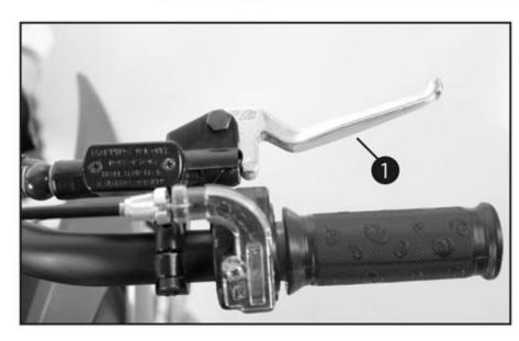
La poignée de frein à main avant 1 est située à droite du guidon. Le frein avant est actionné par la poignée de frein à main.
