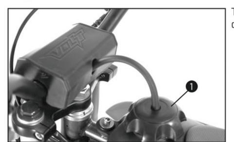
Tourner le bouchon du réservoir 1 dans le sens inverse des aiguilles d'une montre et le retirer par le haut.
