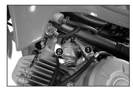
Le réglage de ralenti du carburateur a une forte incidence sur le comportement au démarrage, la stabilité du ralenti et la réponse du carburateur lors d'accélérations. Ceci signifie que lorsque le ralenti est réglé correctement, le moteur démarre plus facilement que lorsque le ralenti est mal réglé.
