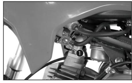
Le robinet de carburant 1 se trouve du côté gauche du réservoir de carburant.
