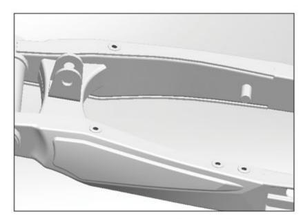
Contrôler l'état du bras oscillant, l'absence de fissures et de déformation.
