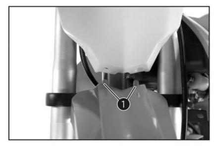
• Positionner le garde-boue de manière à ce que les alésages 1 se trouvent dans les crochets de la plaque frontale.
