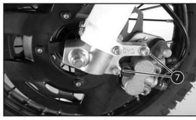
• Positionner l'étrier de frein, mettre les vis 7 en place et serrer.
