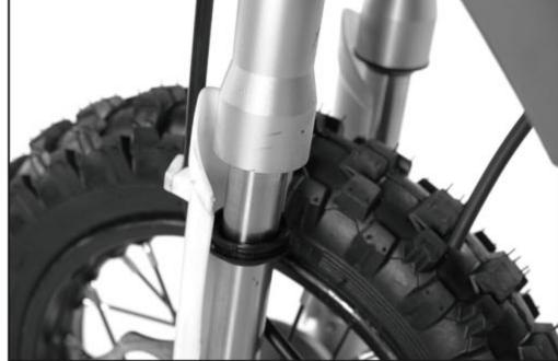
Les cache-poussière 1 ont pour but d'essuyer la poussière et la saleté qui se déposent sur les tubes de fourche. Avec le temps la saleté peut toutefois passer derrière le cache-poussière. Si on ne l'enlève pas, c'est l'étanchéité des joints spi qui peut être remise en cause.
