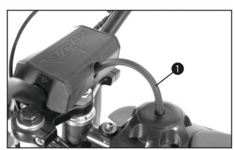
Mettre en place le bouchon du réservoir et le tourner dans le sens des aiguilles d'une montre.
