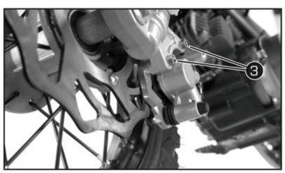
• Positionner l'étrier de frein, mettre les vis 3 en place et serrer.
