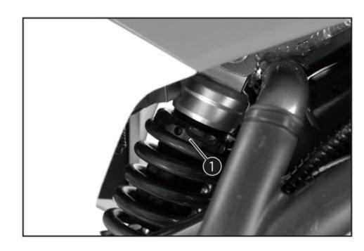
La précontrainte du ressort se règle en tournant la bague 1. Pour ce faire il est préférable de déposer l'amortisseur et de le nettoyer à fond.
