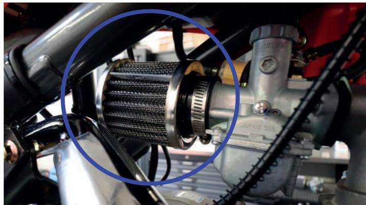
Votre moto dispose d'un filtre à air de 38mm sur votre carburateur. Ce filtre est métallique pour respecter une norme anti-feu. Ce filtre est particulièrement basique et ne filtre pas aussi bien qu'un filtre mousse.
