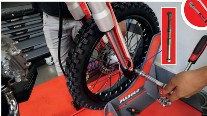
Montez la roue avant en utilisant l'axe fourni.
