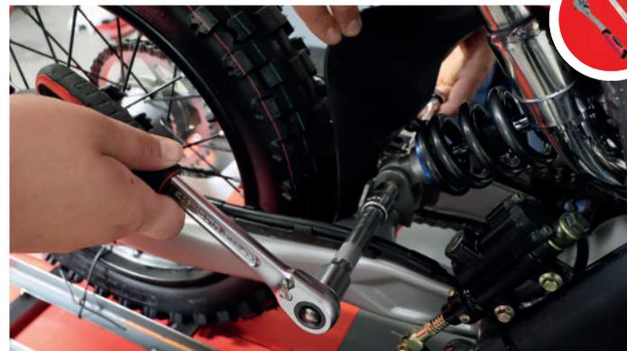
Insérez, et vissez le boulon sur l'écrou afin de fixer l'amortisseur arrière.
