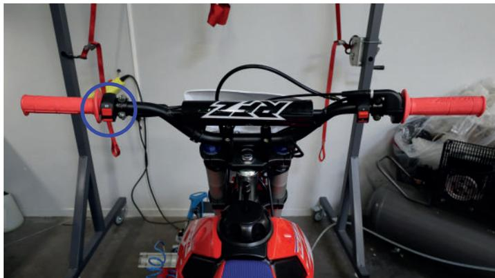
La commande d'arrêt du moteur coupe immédiatement le moteur. Suite à un accident, si la moto se retrouve sur son côté, il suffit d'appuyer sur ce bouton pour arrêter le moteur.
