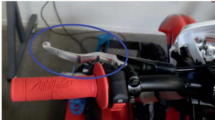
Le levier d'embrayage (à gauche) permet de changer de vitesse en douceur. Serrez la poignée d'embrayage de la main gauche à chaque fois que vous souhaitez changer de vitesse. Il faut toujours se servir de l'embrayage pour changer de vitesse, au risque d'endommager la boîte de vitesses, sauf pour les modèles semi-automatiques.
