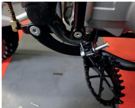
Insérez dans l'espace prévu à cet effet le ressort avec le côté courbé au bout en premier en même temps que le cale-pied. Insérez par le dessus la tige avec le trou dans l'orifice.
