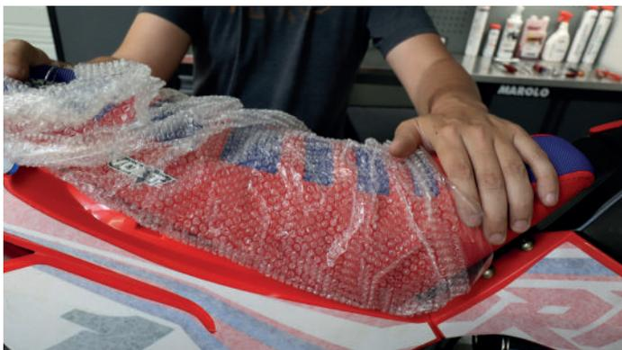
Appuyez sur la selle et faites la glisser vers l'arrière. Réalisez la procédure en sens inverse pour la repositionner.
