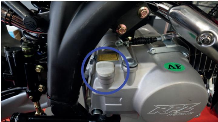
Le bouchon de réservoir d'huile permet d'accéder à la jauge de réservoir. Sur cette jauge, vous allez pouvoir contrôler le niveau d'huile présent dans le moteur de votre véhicule
