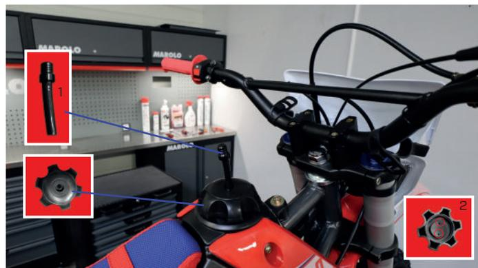
Placez le bouchon de réservoir, ainsi que la valve de mise à l'air (1). Vérifiez que le bouchon est bien percé (voir photo 2).
