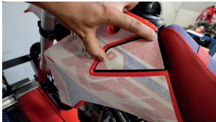
Collez les stickers du kit déco fournis sur les parties noires de chaque côté du réservoir à essence.
