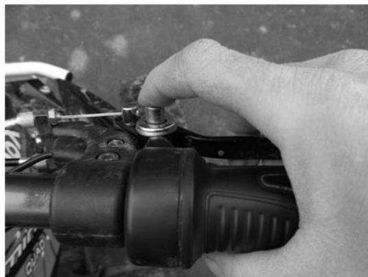
Un frein de stationnement est disponible sur le levier de frein droit. Tirez sur le levier et appuyez sur le bouton pour enclencher le frein, puis lâchez le levier de frein. Pour le désengager, tirer à nouveau sur le levier, le frein se désengage automatiquement.
